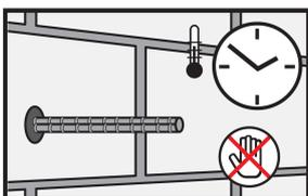
Durante o tempo de endurecimento da resina, a barra não deve ser movida ou carregada. Lavar as ferramentas imediatamente com o Sika Colma Cleaner. Lave bem as mãos e a pele com água quente e sabão.
