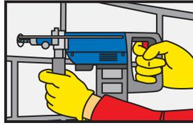
Execute a perfuração do furo com uma broca elétrica de acordo com o diâmetro e a profundidade necessária. O diâmetro do furo de perfuração deve estar de acordo com o tamanho da broca.
