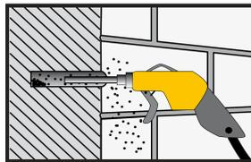
O furo de perfuração deve ser limpo com ar comprimido uma vez mais, usando uma bomba de ar, a partir do fundo do furo. (pelo menos 2x) até o fluxo de ar de retorno estar livre de poeira visível.
