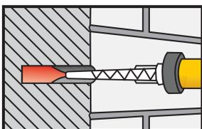
Injetar o adesivo no furo, começando no fundo do furo, enquanto retira lentamente o misturador estático. Em qualquer caso, evite travar o ar. Podem ser utilizados tubos de extensão em caso de furos profundos.
