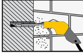
O furo de perfuração deve ser limpo com ar comprimido, usando uma bomba de ar, a partir do fundo do furo. (pelo menos 2x) até o fluxo de ar de retorno estar livre de poeira visível.
